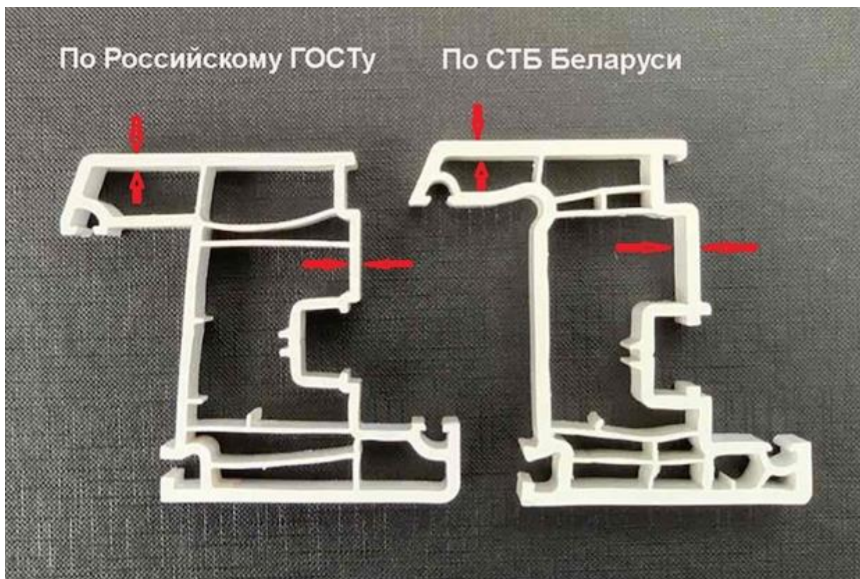
ПВХ-профиль класса «В» российского (слева) и белорусского (справа) производства
